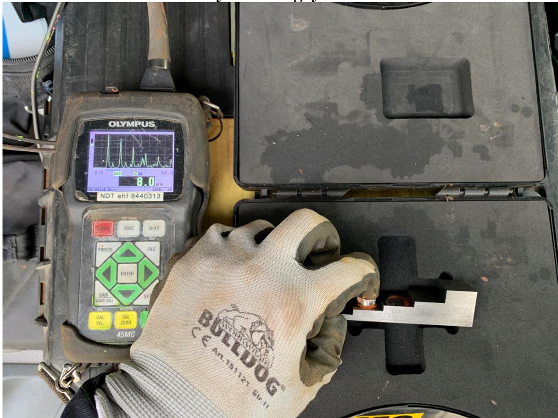
Mynd 1. Mælir prófaður á kvörðunarblokk fyrir mælingar.
